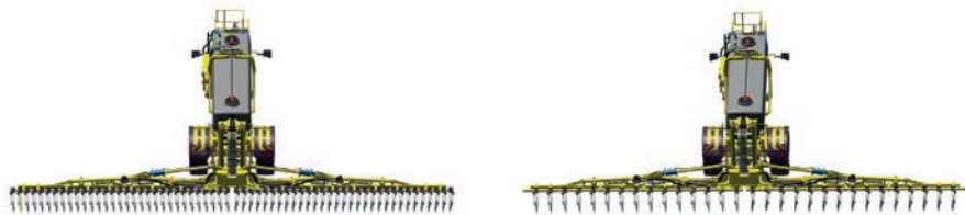
Obr. 29: Konstruktivní řešení pro injektážní aplikaci jedné kapalně látky v mezíporostním období (stroj je vybaven jedním centrálním zásobníkem), vlevo je rozteč injektážních kol 0,25 m a vpravo jejich rozteč činí 0,5 m (zdroj BEDNAR FMT).
