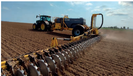
Obr. 32: Pracovní souprava při aplikaci pomocné látky ESCUBE do budoucího řádku ozimé řepky. Aplikace probíhala ob kotouč, tedy pro rozteč řádků 0,5 m (foto Brant).
