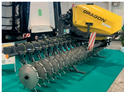
Obr. 9: Zásobníky mohou být umístěny přímo na rám aplikátoru (foto Chára).
