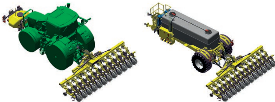
Obr. 38: Pracovní soupravy s čelním zavěšením nádrže na kapalné látky (vlevo) a pracovní souprava se zavěšením meziřádkového kultivátoru (plečky) na rámu samostatného podvozku nosiče nádrže osazeného tříbodovým závěsem.
