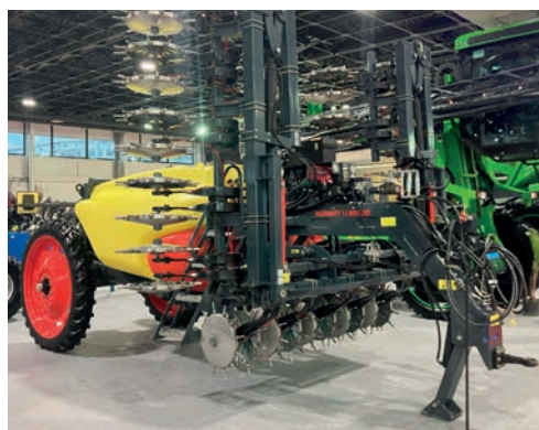
Obr. 3: Implementace systému CULTAN pro aplikaci k řádku rostlin pěstovaných v širších řádcích (foto Chára).
