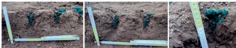
Obr. 15: Stav infiltrace kapaliny do půdy při použití aplikačních hřebů s rozdílným tvarem zakončení (foto Brant).
