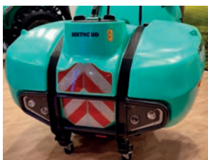
Obr. 8: Při využití aplikátorů pro injektážní aplikaci jako nesených strojů jsou tažné prostředky primárně osazovány čelně nesenými nádržemi (foto Brant).
