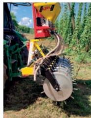
Obr. 40: Pracovní souprava vybavená rámem s aplikačními koly pro injektážní vnos kapalných látek do půdy. Souprava disponuje dvěma rozvody kapaliny na rámu, které umožňují individuální nezávislou aplikaci dvou rozdílných látek v závislosti na připojení daného aplikačního kola (foto Brant).
