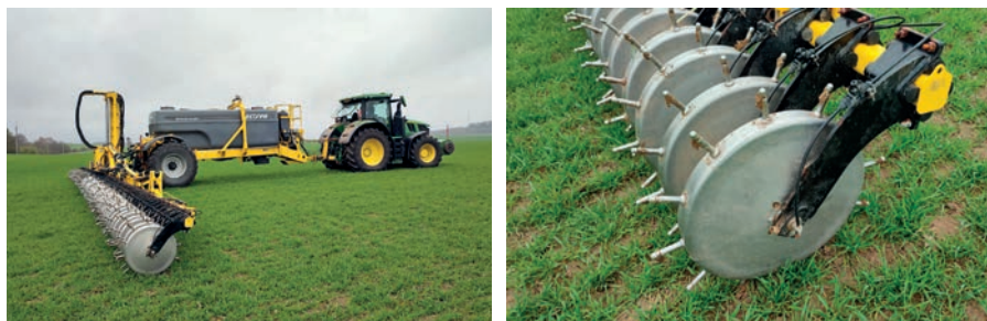
Obr. 18: Aplikace hnojiva DAM 390 pomocí prototypu NEVEON BEDNAR FMT o pracovním záběru 20 m s roztečí mezi aplikačními koly s injektážními hroty 0,25 m (foto Brant).
