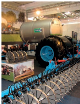
Obr. 6: U komerčně nabízených řešení se nejčastěji jedná o konstrukce, kdy je na rámu s jednonápravovým podvozkem umístěna nádrž na kapalinu a pomocí tříbodového závěsu je poté připojen samotný aplikátor pro injektážní aplikaci (foto Brant).
