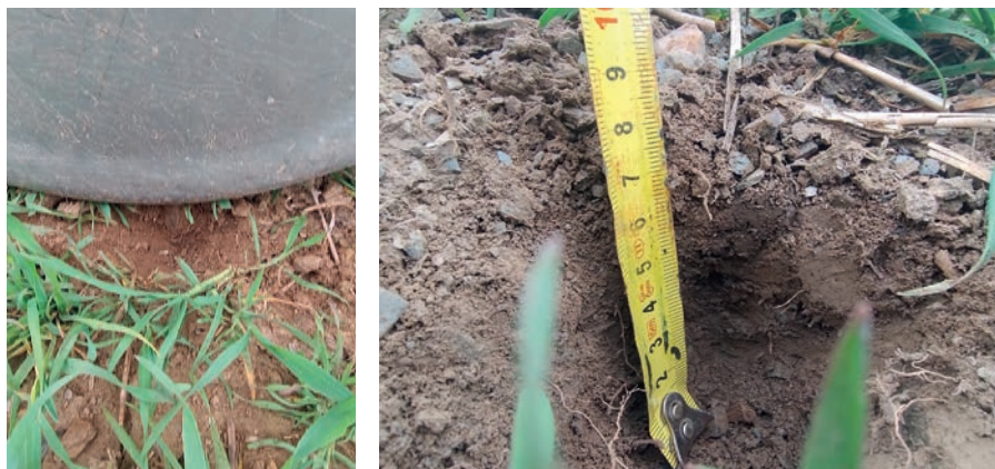
Obr. 20: Hnojivo bylo při aplikaci aplikačními hroty ukládáno do hloubky kolem 70 mm (foto Brant).
