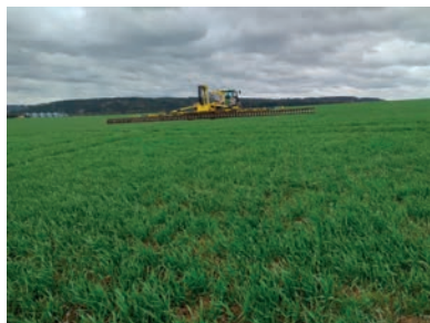
Obr. 35: Pracovní souprava osazená jednokomorovým zásobníkem kapalných látek s tříbodovým závěsem v kombinaci s rámem s aplikačními koly při jarním regeneračním hnojení ozimé pšenice, vlevo je souprava při práci, vpravo je schéma soupravy. Rozteč aplikačních kol činí 0,25 m (zdroj BEDNAR FMT).
