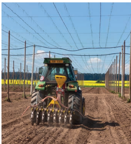
Obr. 40: Pracovní souprava vybavená rámem s aplikačními koly pro injektážní vnos kapalných látek do půdy. Souprava disponuje dvěma rozvody kapaliny na rámu, které umožňují individuální nezávislou aplikaci dvou rozdílných látek v závislosti na připojení daného aplikačního kola (foto Brant).
