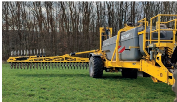
Obr. 6: U komerčně nabízených řešení se nejčastěji jedná o konstrukce, kdy je na rámu s jednonápravovým podvozkem umístěna nádrž na kapalinu a pomocí tříbodového závěsu je poté připojen samotný aplikátor pro injektážní aplikaci (foto Brant).
