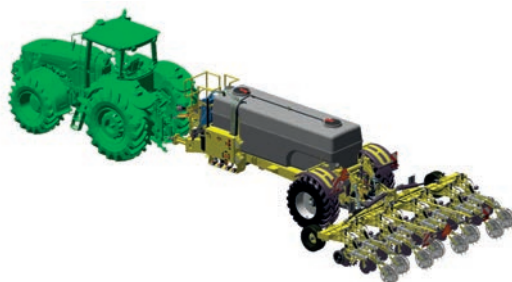
Obr. 34: Pracovní souprava osazená zásobníkem kapalných látek s tříbodovým závěsem, do kterého je následně připojen stroj pro pásové zpracování půdy (zdroj BEDNAR FMT).
