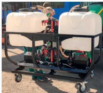
Obr. 5: Systém rozvodů pro individuální přívod dvou kapalin k aplikačním kolům a čelně nesený zásobník kapaliny se dvěma nádržemi a nezávislými čerpadly (foto Brant a Kroulík).
