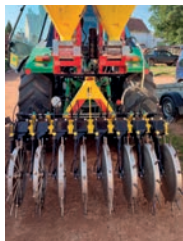
Obr. 40: Pracovní souprava vybavená rámem s aplikačními koly pro injektážní vnos kapalných látek do půdy. Souprava disponuje dvěma rozvody kapaliny na rámu, které umožňují individuální nezávislou aplikaci dvou rozdílných látek v závislosti na připojení daného aplikačního kola (foto Brant).
