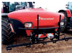
Obr. 8: Při využití aplikátorů pro injektážní aplikaci jako nesených strojů jsou tažné prostředky primárně osazovány čelně nesenými nádržemi (foto Brant).
