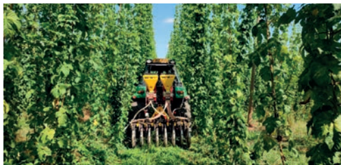
Obr. 40: Pracovní souprava vybavená rámem s aplikačními koly pro injektážní vnos kapalných látek do půdy. Souprava disponuje dvěma rozvody kapaliny na rámu, které umožňují individuální nezávislou aplikaci dvou rozdílných látek v závislosti na připojení daného aplikačního kola (foto Brant).
