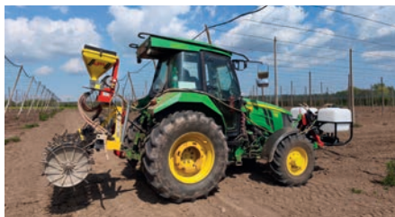
Obr. 41: Souprava při aplikaci půdních bakterií do meziřadí celoplošně kultivované chmelnice se souběžnou aplikací mikrogranulátu bioagens na řádek chmele před priorávkou (foto Brant).
