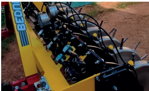
Obr. 5: Systém rozvodů pro individuální přívod dvou kapalin k aplikačním kolům a čelně nesený zásobník kapaliny se dvěma nádržemi a nezávislými čerpadly (foto Brant a Kroulík).
