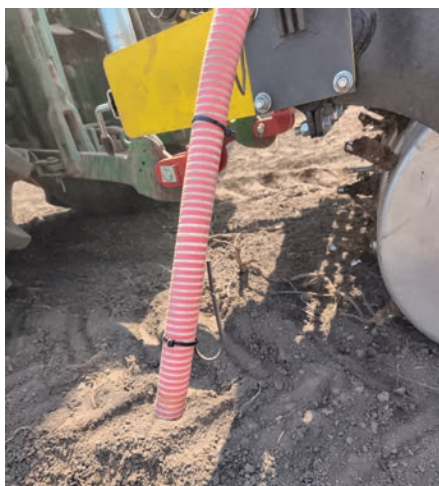
Obr. 40: Pracovní souprava vybavená rámem s aplikačními koly pro injektážní vnos kapalných látek do půdy. Souprava disponuje dvěma rozvody kapaliny na rámu, které umožňují individuální nezávislou aplikaci dvou rozdílných látek v závislosti na připojení daného aplikačního kola (foto Brant).
