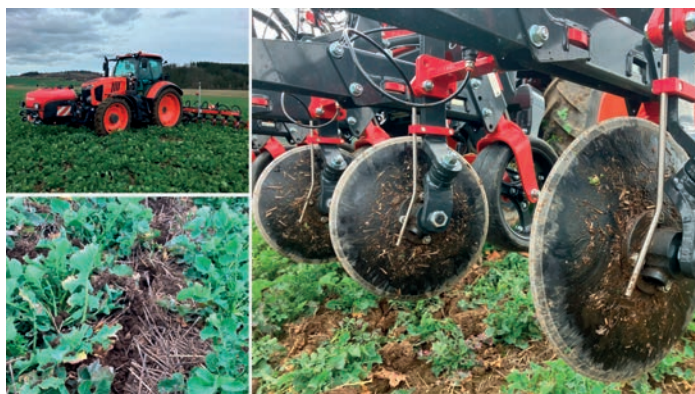
Obr. 13: Modifikace plečky pro aplikaci hnojiva za řezný disk k řádku ozimé řepky na jaře (foto Chára).
