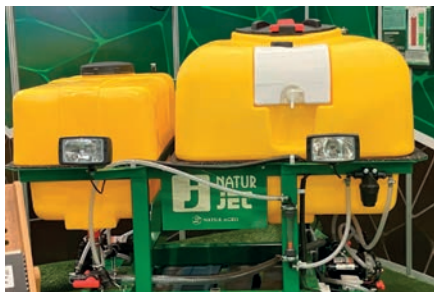
Obr. 10: Komerčně jsou nabízeny i čelně nesené nádrže se dvěma oddělenými zásobníky (foto Chára).
