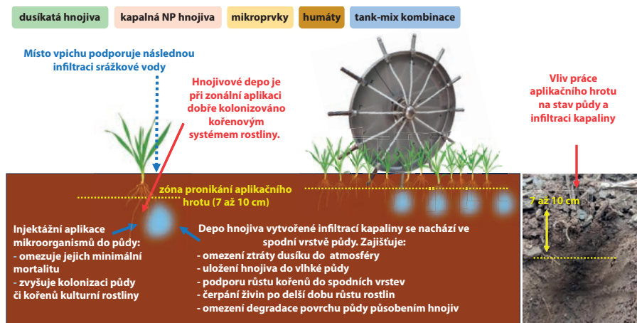
Obr. 46: Jarní zonální injektážní aplikace kapalných látek do obilnin vysetých do řádku či do pásu. Porosty založené do technologií se zapravením rostlinných zbytků (zdroj BEDNAR FMT).
