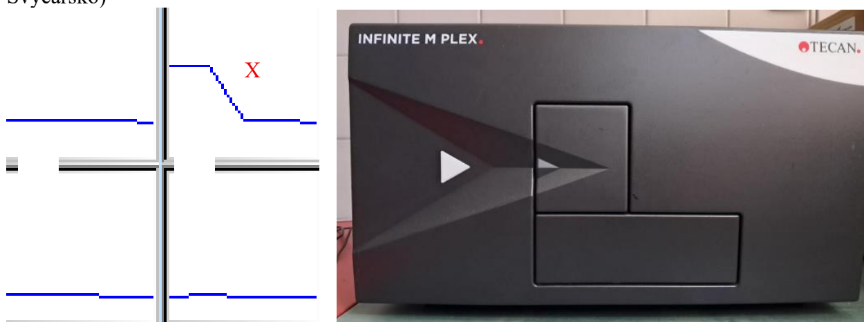
Obrázek 10. Grafické znázornění změn hodnot absorbance v čase v průběhu měření u čtyř vzorků (vlevo) a přístroj Tecan Infinite M Plex multimode microplate reader (Männedorf, Švýcarsko)
