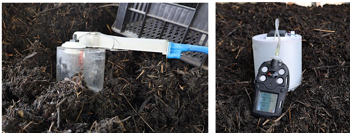
Obr. 7 a 8: Měření emisí pomocí LCpro+ (vlevo) a WatchGas POLI (vpravo).
