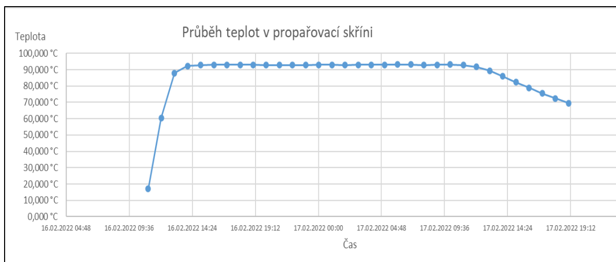
Graf 1 Příklad standardního průběhu teplot během teplotního ošetření substrátu pro pěstované houby
