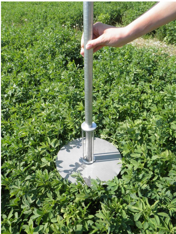
Obrázek 2 Měření výšky porostu pomocí talířového měřidla.
