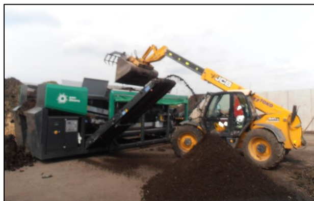
Obr. 4; 5: Hvězdicové síto a následná úprava hotového vermikompostu
