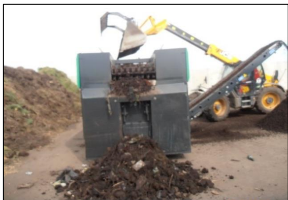
Obr. 4; 5: Hvězdicové síto a následná úprava hotového vermikompostu
