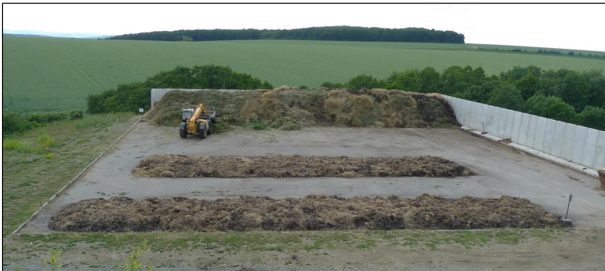
Obr. 3: Vermikompostování biologicky rozložitelného komunálního odpadu v podobě pásových hromad
