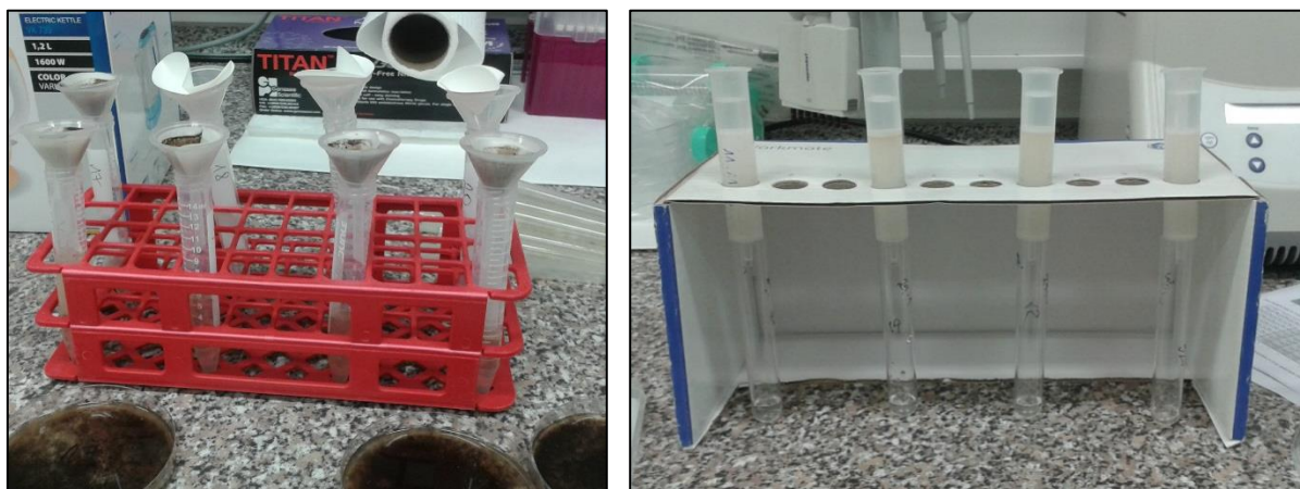
Obr. 14; 15: Filtrace (vlevo) a následné odsolení vzorků (vpravo)
