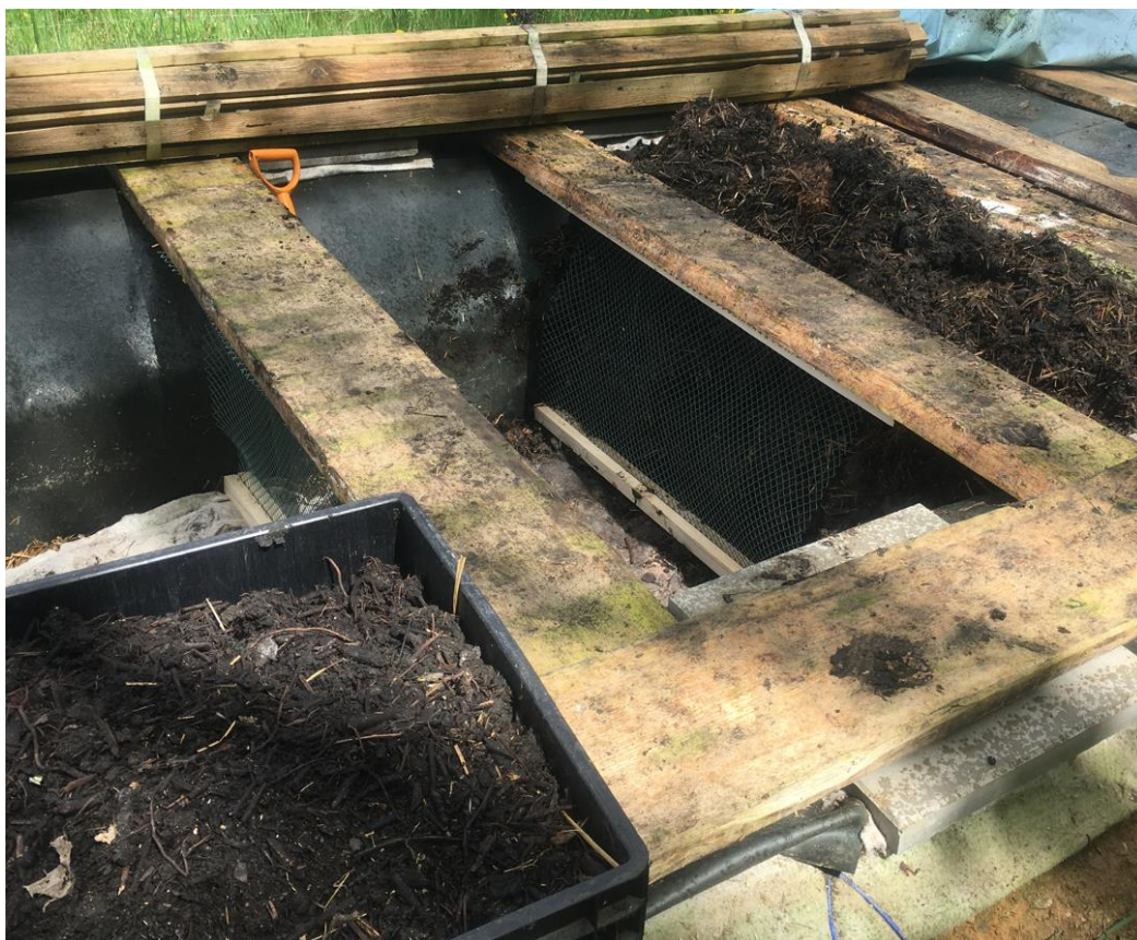
Obr. 8: Rozdělení jedné z komor vermikompostéru perforovanými přepážkami (segment napravo obsahuje žížalí násadu z předchozí sezóny, v přepravce je připravena směs kalu se štěpkou pro umístění do prostředního segmentu)
