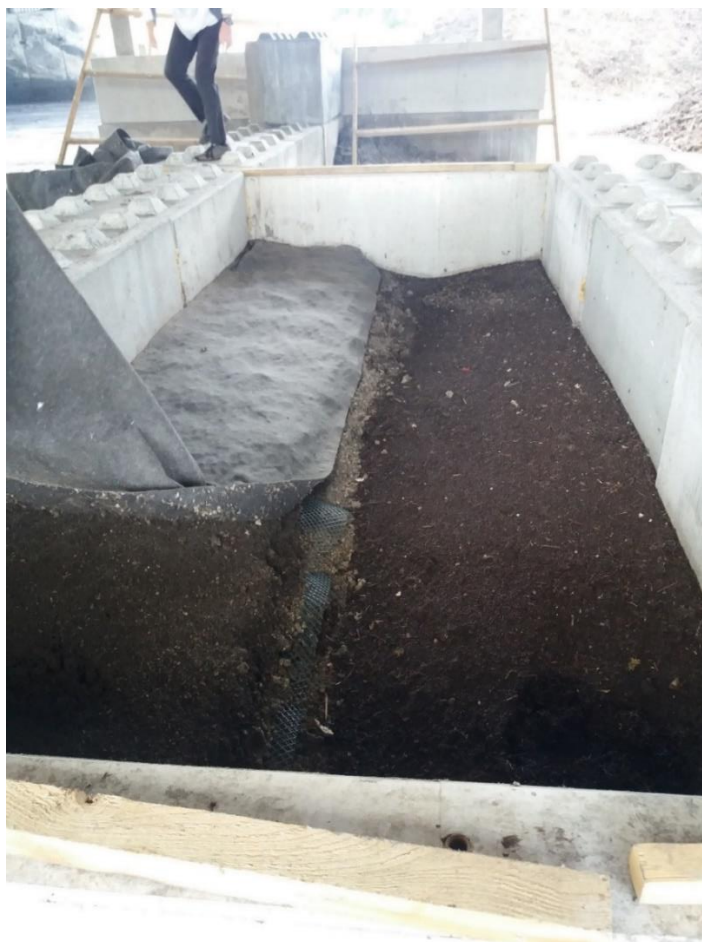
Obr. 11: Vermikompostování směsi kalu s proložkami od vajec v betonových kójiích
