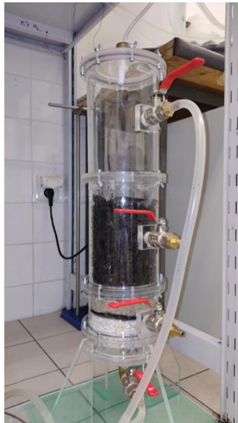
Obrázek 3: Konstrukce filtračních kolon použitých v rámci experimentů
