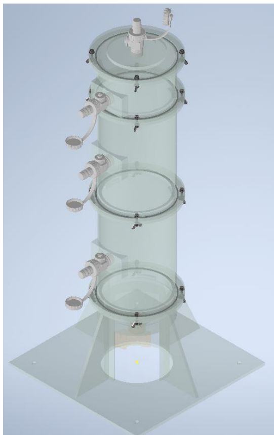
Obrázek 3: Konstrukce filtračních kolon použitých v rámci experimentů
