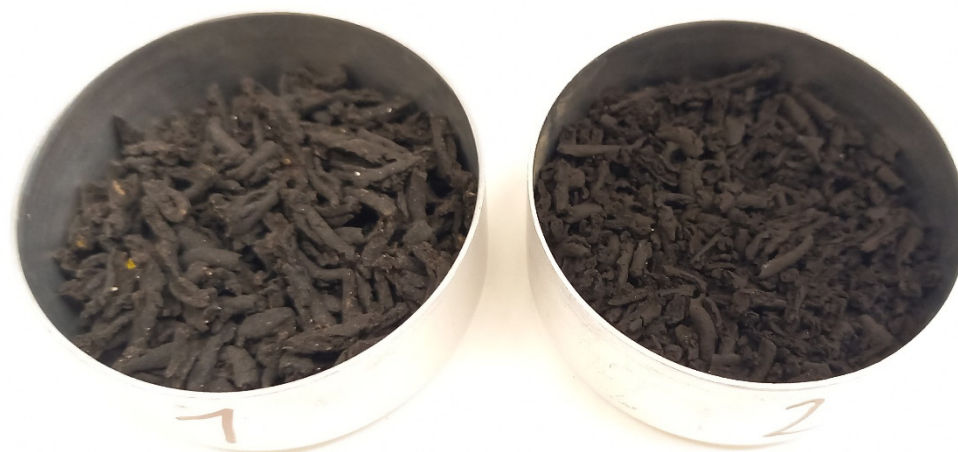
Obr. 11. Kal strojově sušený v provozu ČOV a výsledek jeho torefakce 18
