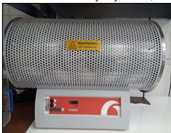
Obr. 1: Elektrická pec na laboratorní pyrolýzu čistírenského kalu
