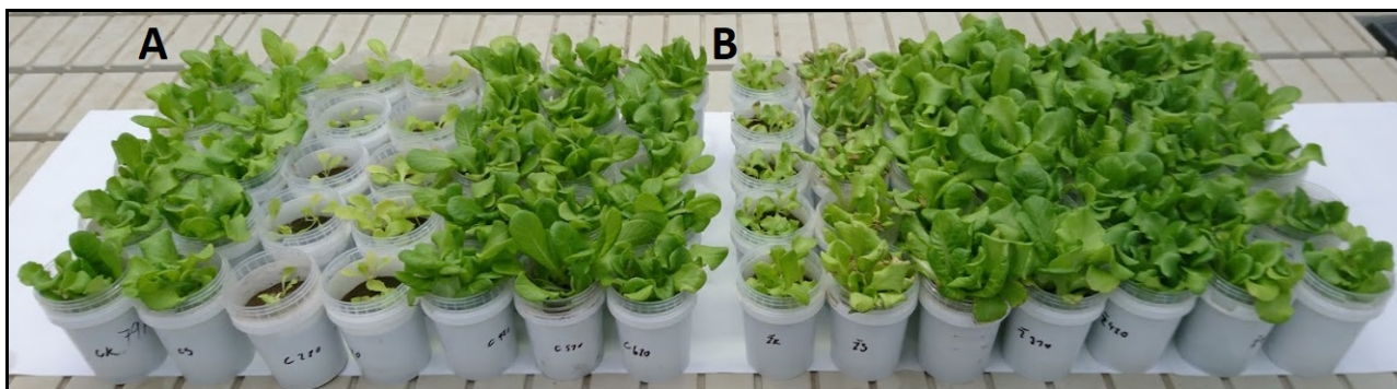
Obr. 3: Salát pěstovaný na půdě (A: fluvizem – Cítov, B: kambizem – Žamberk) s přidávkou pyrolyzovaných materiálů v nádobovém pokusu na ověření transferu reziduí léčiv z čistírenských kalů do biomasy 9
