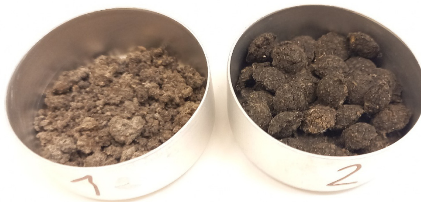
Obr. 7: Odvodněný kal a pelety kalů pro výrobu hnojiv pomocí torefakce
