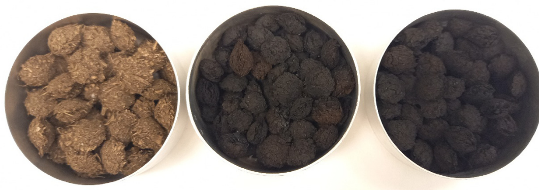
Obr. 10. Sušené a torefikované pelety z odvodněného kalu s aditiv 17
