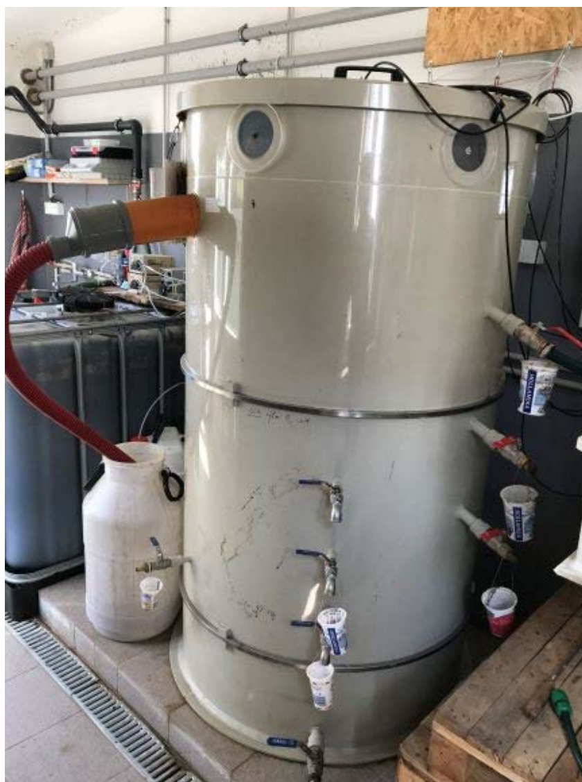
Obrázek 11: Poloprovozní reaktor využitelný jako součást mobilní jednotky pro kultivaci nitrifikační biomasy zpracovávající fugát
