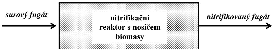
Obrázek 4: Schematické znázornění funkce systému pro zpracování fugátu pracujícího na principu kombinace biomasy kultivované v suspenzi a v biofilmu
