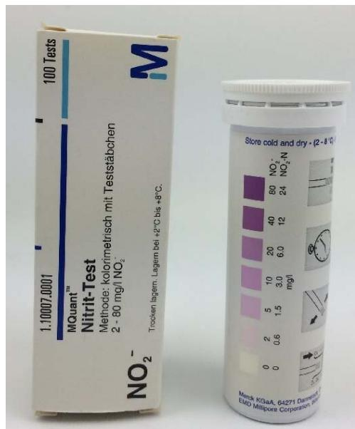
Obrázek 7: Kolorimetrické testy pro orientační stanovení koncentrace  $N\text{-NO}_2^-$
