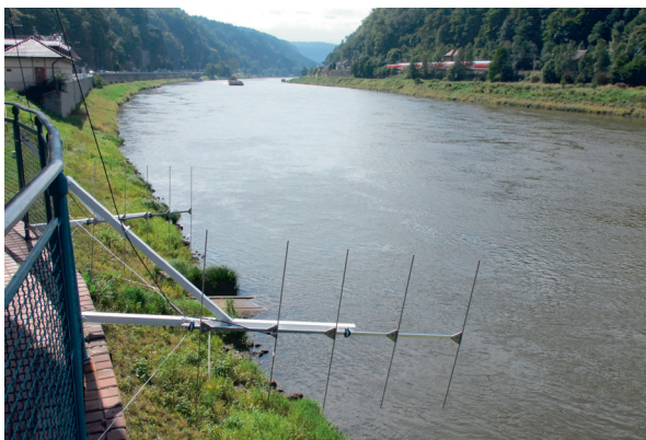
Obr. 14. Umístění antén stacionární automatizované stanice na Labi ve Hřensku (Foto P. Horký).
