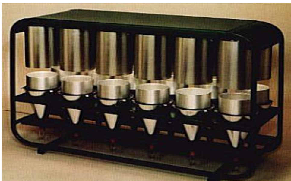
Obr. 8: Fototermosteklektor typu Berlese – Tullgren
