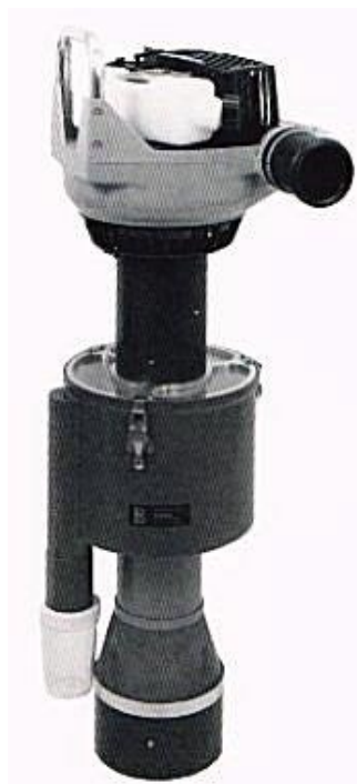
Obr. 6: Speciální vysavač na vysávání hmyzu z povrchu země či vegetace
