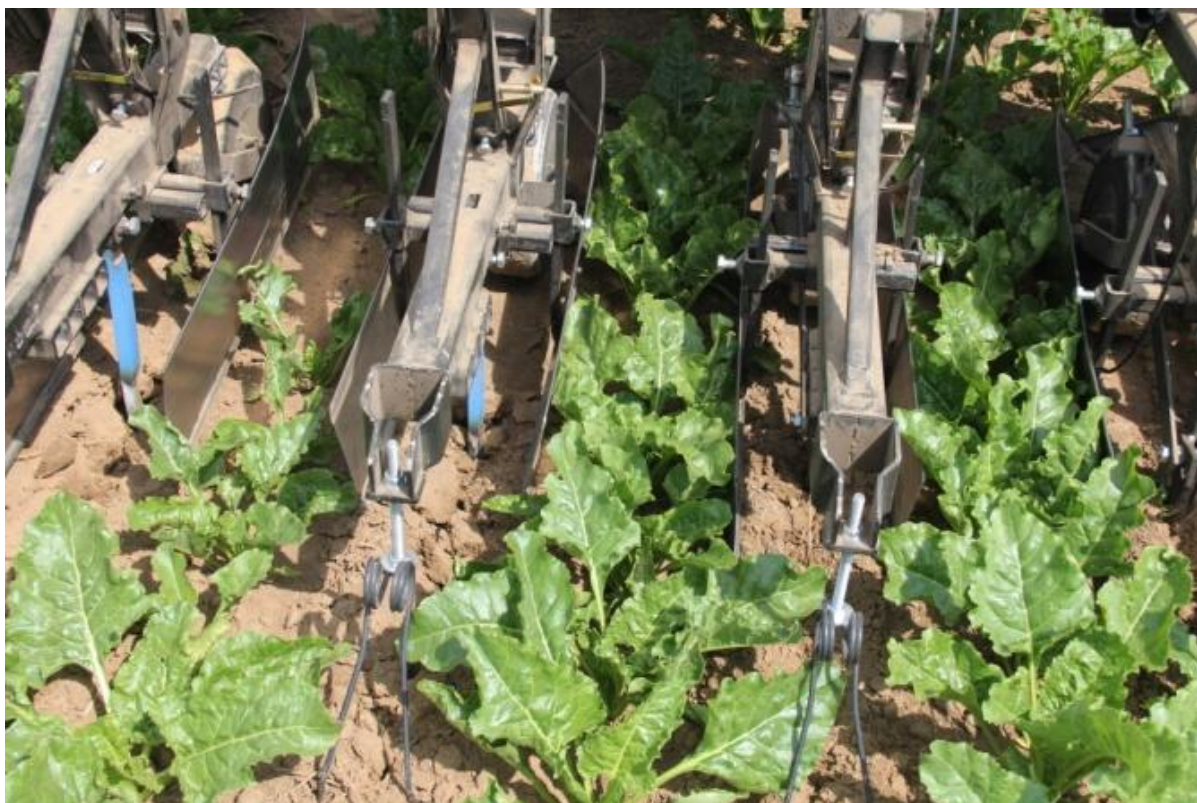
Obr. 15: Dlátování, poslední hlubší kypření porostu cukrové řepy před zapojením porostu.
