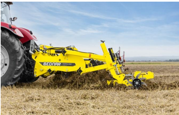
Obr. 17: Hluboké kypření půdy (25 - 35 cm) pro cukrovou řepu po obilnině, menší část strniště zůstává na povrchu půdy a působí jako protierozní ochrana půdy.
