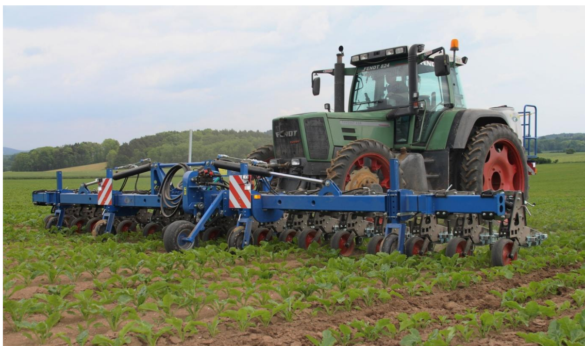
Obr. 10: Plečkování porostu cukrové řepy kypřičem MeKy.
