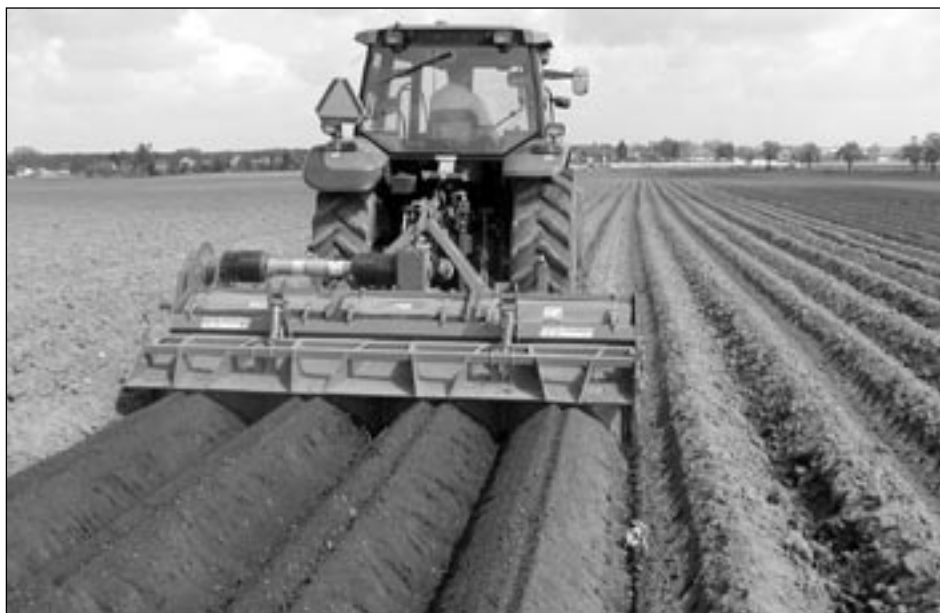
Obr. 8: Tvarování hrůbků po výsadbě rotační plečkou
