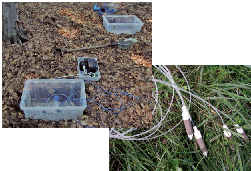
Obr. 2: Příprava k instalaci sukčních lyzimetrů (foto T. Čihák)
