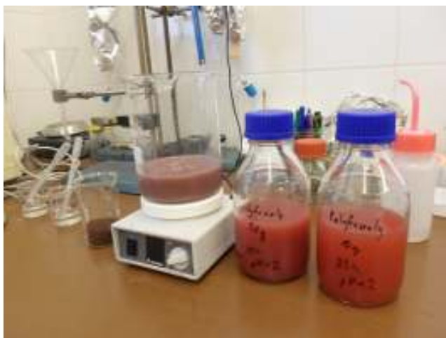
Fig.2: Vaření suspenze a filtrát připravený k separování polyfenolů na koloně
