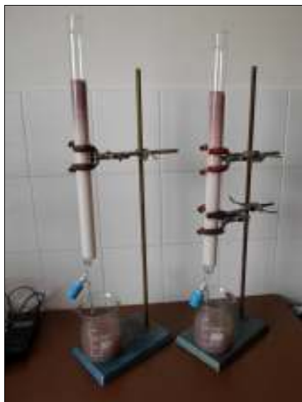
Fig.3: Separační kolona s Amberlitem při průchodu vzorku
