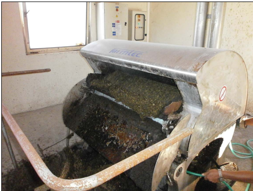
Obr. 1. Separátor (BPS Krásná Hora nad Vltavou)
