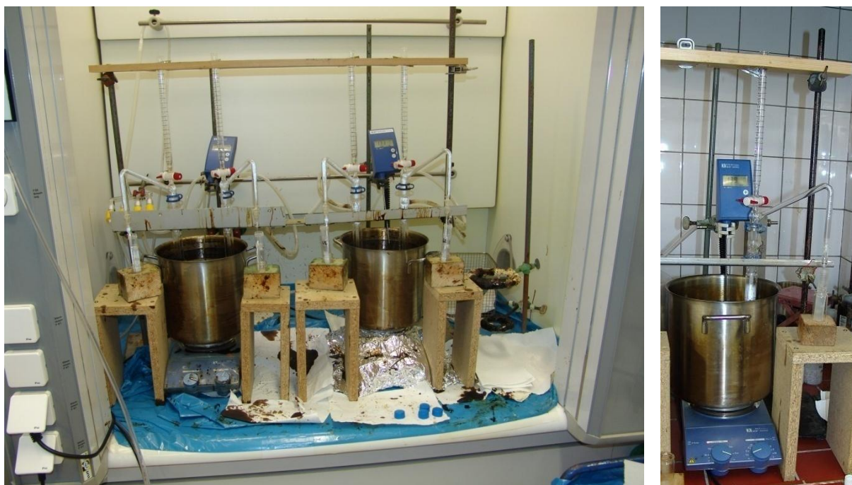
Obr. 4: Kompletní sestava 4 JN Apparátů při extrakci
