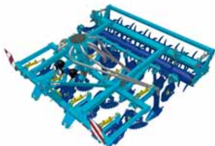
Obr. 6: Čtyřřádkové provedení stroje pro intenzivní pásové kypření s možností aplikace hnojiva do kypřeného řádku
