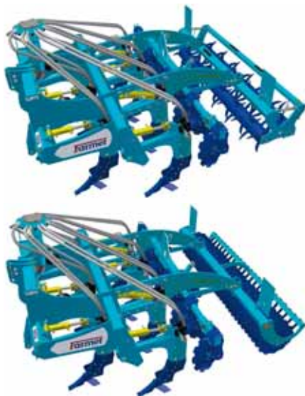
Obr. 11: Konstrukční řešení stroje pro diferencované hluboké kypření s intenzivním celoplošným drobením a mísením horní vrstvy půdy. Nahoře s dvojitými hřbovými válci, dole s diskovým válcem.
