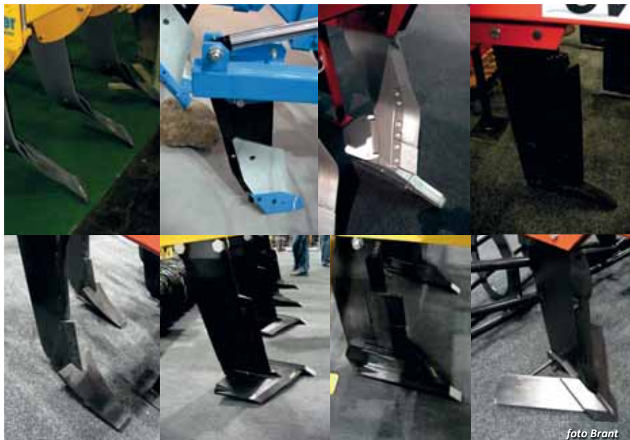
Obr. 3: Příklady rozdílných pracovních nástrojů využívaných pro hlubší kypření půdního profilu s možností zpracování podorníční vrstvy
