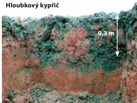
Obr. 14: Simulace infiltrace vody do půdy metodou modré infiltrace na plochách zpracovaných hloubkovým kypřičem a pluhem (28. 11. 2014). Foto Brant.
