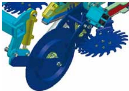
Obr. 4: Detailní zobrazení výškově nastavitelných rozhrnovačů rostlinných zbytků a z krojidla
