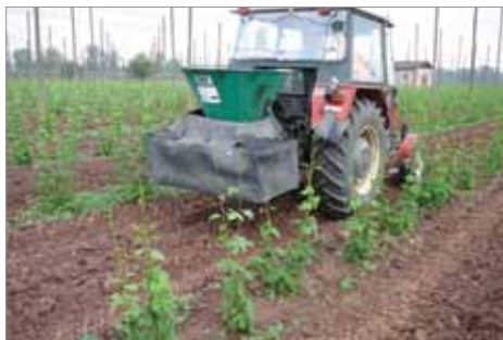
Obr. 3.9: Adaptovaný rozmetač hnojiv pro výsev plodin. Mechanizaci si může pěstitel upravit z použitých zařízení.
