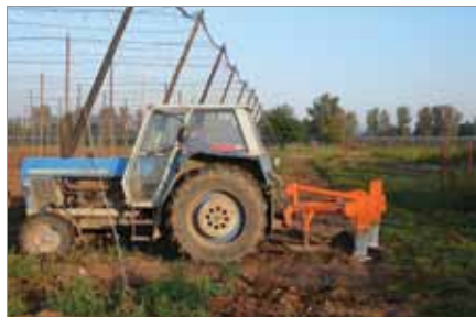
Obr. 3.17: Hloubkový kypřič do kolejových rádků, hloubkový kypřič Bremer
