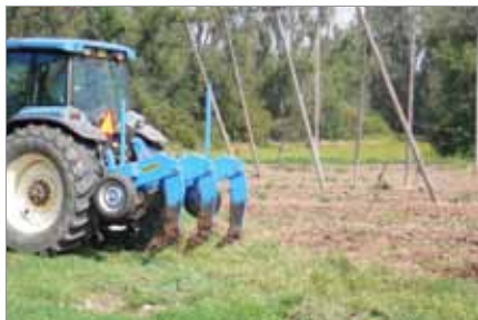
Obr. 3.17: Hloubkový kypřič do kolejových rádků, hloubkový kypřič Bremer
