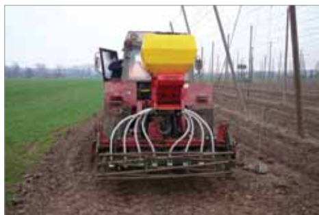
Obr. 3.7: Pneumatický secí stroj s rotačními bránami s prutovým (vlevo), nebo vějířovým válcem (vpravo)
