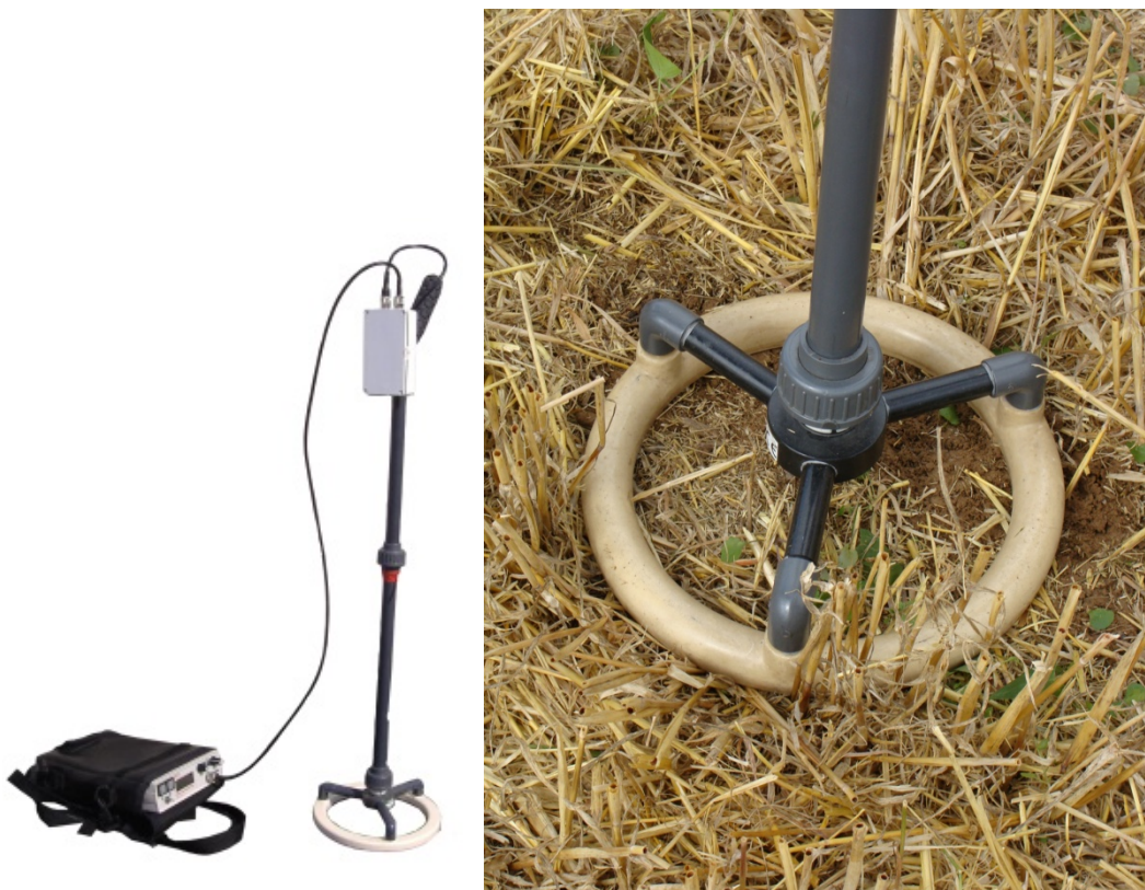
Obr. 3: Polní sonda Bartington MS2D pro měření povrchové susceptibility půd.
