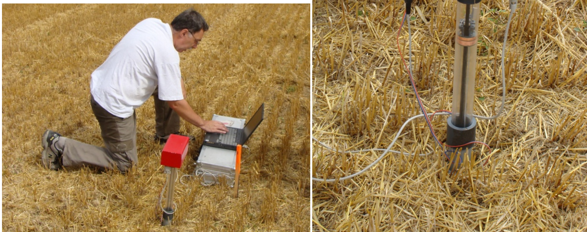
Obr. 5: Kappametr SM400 pro měření magnetické susceptibilitě v hloubkových půdních profilech.
