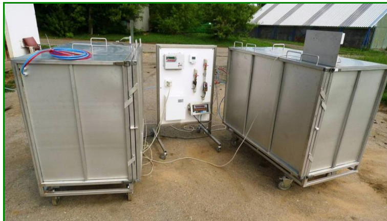
Obr. 5 Dvoumodulový vermireaktor v rozpojeném stavu s hlavním řídicím panelem
