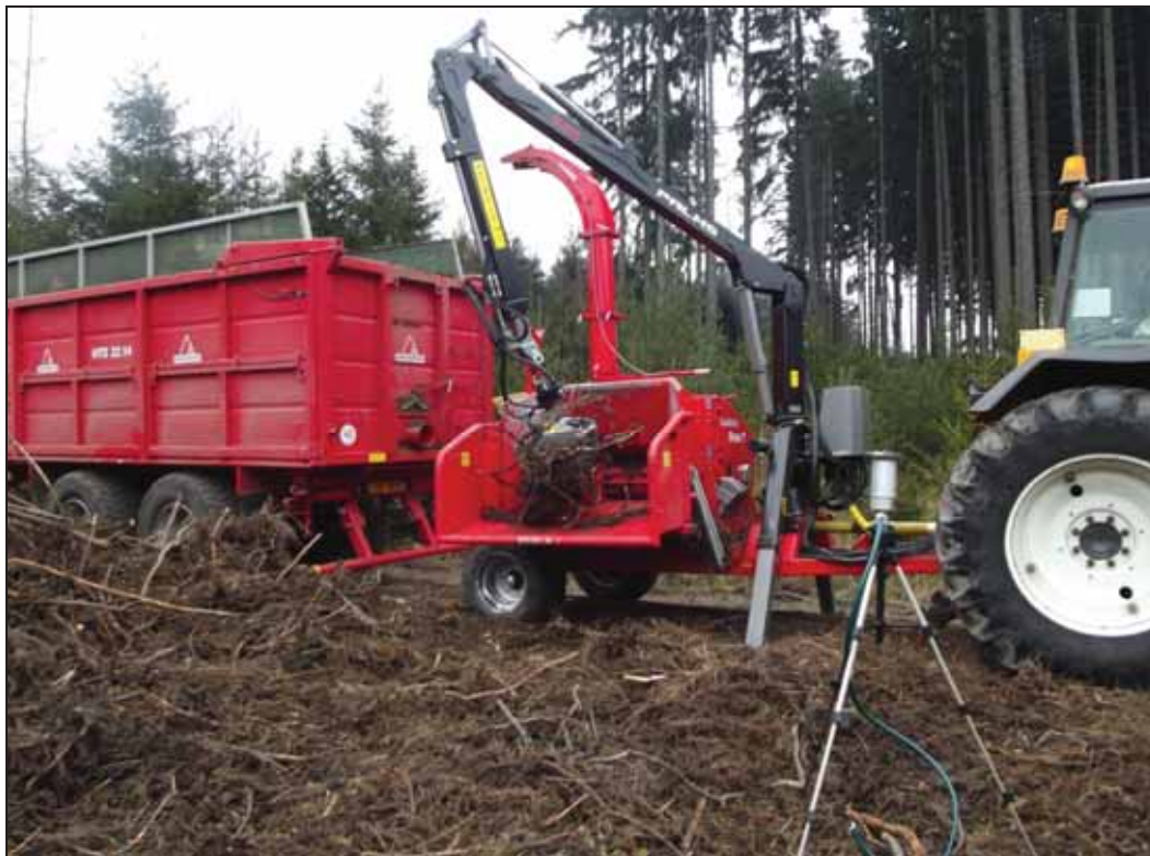
Obrázek 3 Dávkování štěpkované biomasy do podávacího ústrojí štěpkovače
