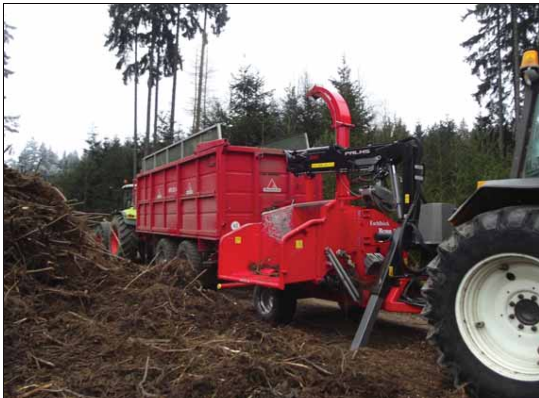
Obrázek 2 Štěpkovač BOBR 7 připojený za traktor JCB-Fastrac s hydraulickou rukou a valník Anaburger s traktorem Class.
