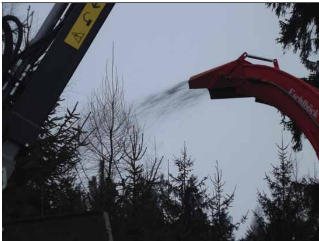
Obrázek 4 Výstupní hrdlo štěpkovače s proudem dřevní štěrky
